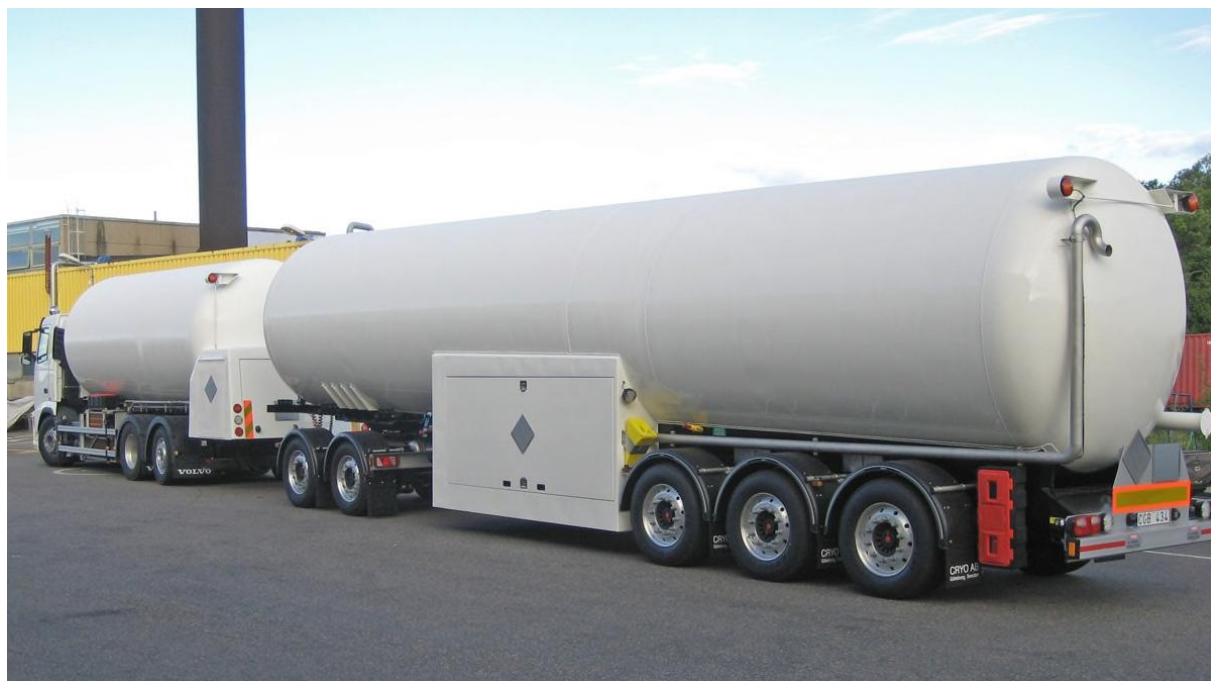
Figur 9 Semitrailer med släpvagn för transport av LNG. Källa: Cryo AB
