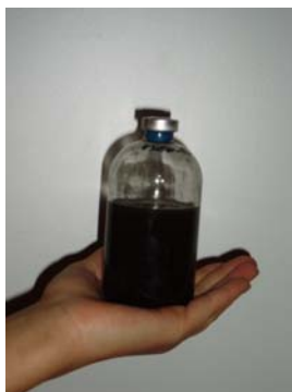
Figur 3. Minirötkammare för satsvist utrotningsförsök på AnoxKaldnes laboratorium i Lund. Foto: My Carlsson.
