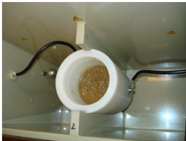
Figur 2. Behållaren för elektroporationsbehandling. Vid varje tillfälle kan ca 1 liter substrat behandlas. Foto: Jurate Kumpiene.
