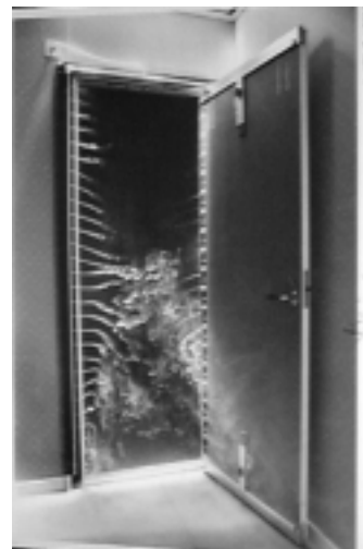
Rökvisualisering av luftströmning genom en dörröppning
